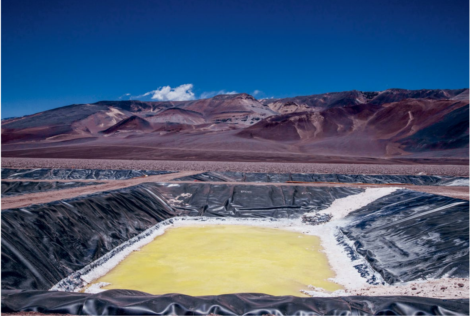
In diesem Becken in der argentinischen Provinz Catamarca verdunstet Sole für den Lithiumgewinn. Foto: Anita Pouchard Serra
